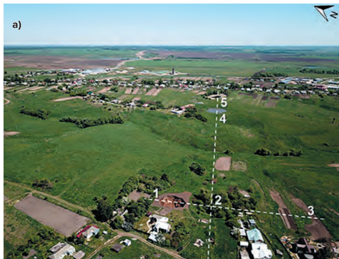
Рис. 3 Аэрофотоснимки с БПЛА 18 мая 2019 г. карстового провала в с. Дедилово (1) в панорамном ракурсе (А) и с близкого расстояния (В). Обозначения: прямые белые пунктирные линии соединяют пять карстовых провалов (1, 2, 3 и 2, 4 и 5)
