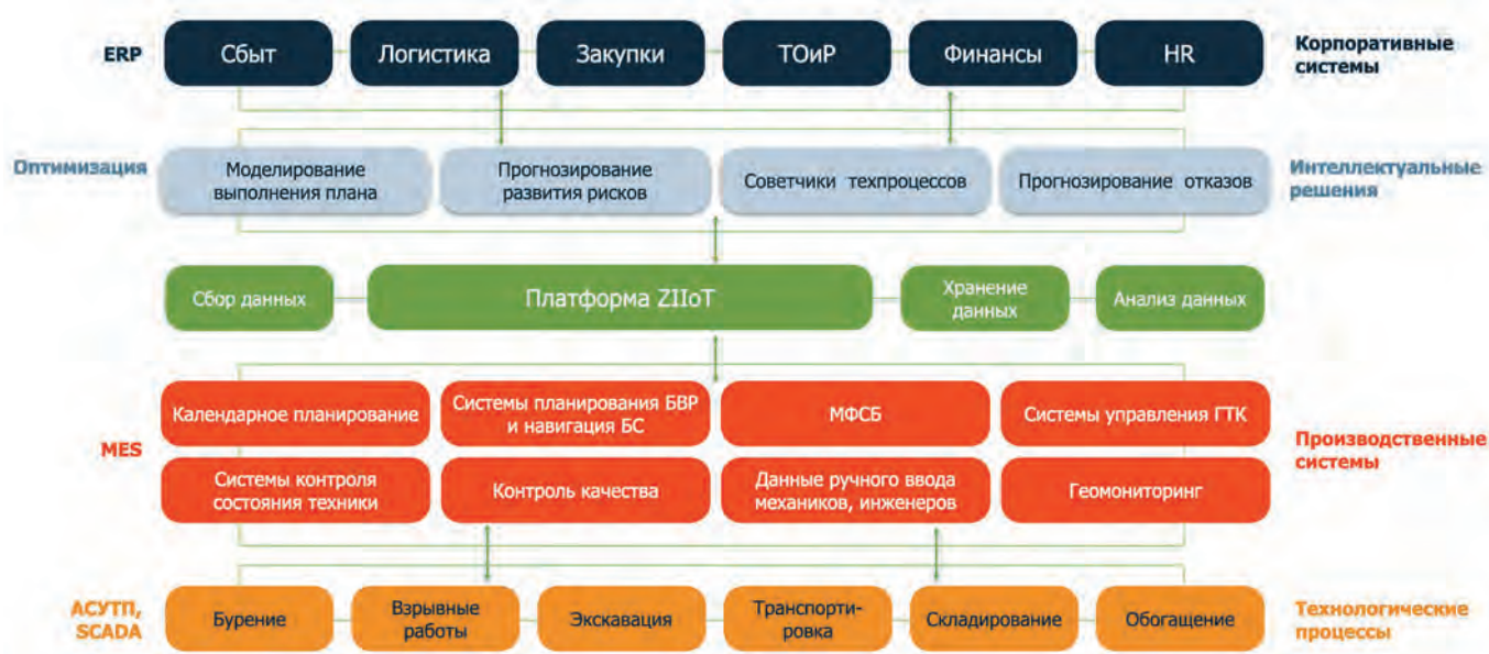
Рис. 3 Комплексная система управления горным производством
