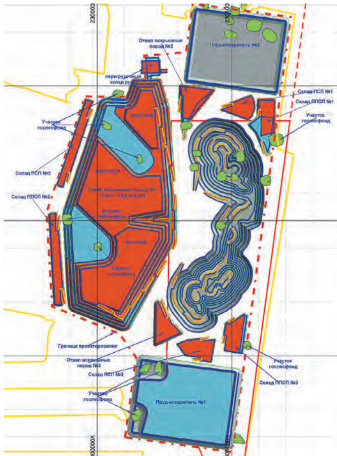
Рис. 6 Пример размещения отвалов и складов с учетом сохранения лесных участков
