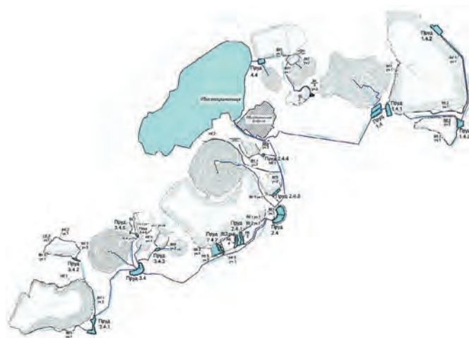
Рис. 5 Структура схемы системы оборотного водоснабжения
