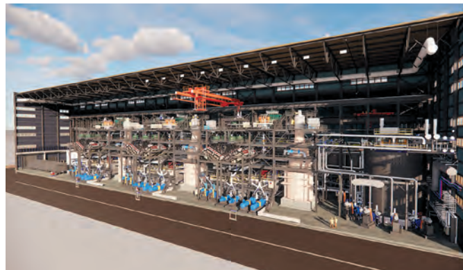
Рис. 10 3D модель корпуса дообогащения с размещением технологического оборудования (вид со стороны грохотов и мельниц)
