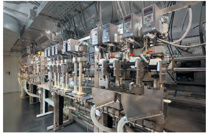
Рис. 7 Участок флотационного обогащения опытно-промышленной установки (фактическое исполнение)
