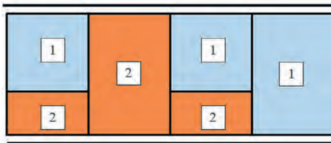
Рис. 1 Комбинирование технологий погашения выработанного пространства: 1 – хвосты выщелачивания; 2 – твердеющие смеси
