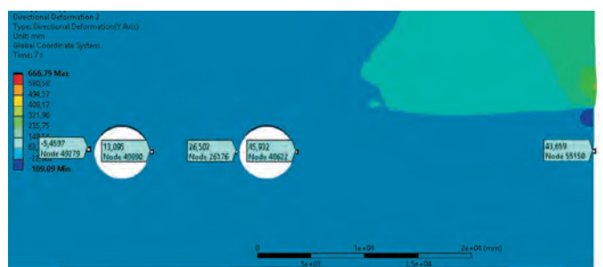
Рис. 7.8 Фронт 28,5 м, смещение от тоннеля
