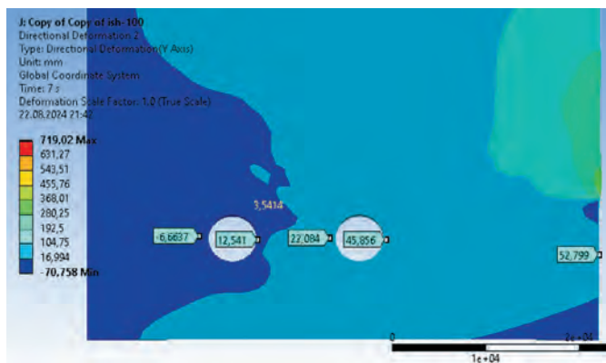
Рис. 7.6 Фронт 22,5 м, смещение от тоннеля
