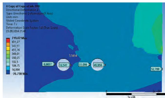
Рис. 7 Расположение ключевых точек (в качестве примера приведен вариант расчета при фронте смещения в 22,5 м от кромки тоннеля, направление смещения – от тоннеля)
