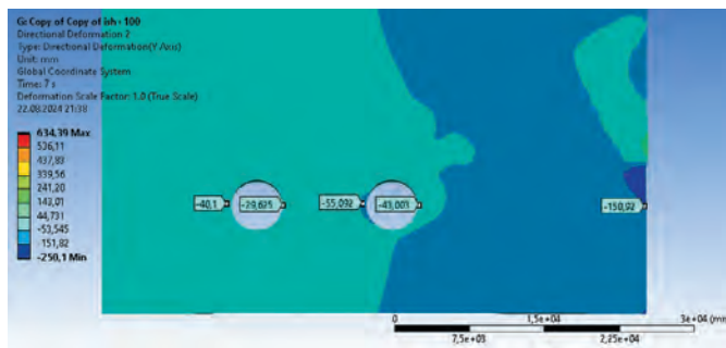
Рис. 7.5 Фронт 22,5 м, смещение по направлению к тоннелю
