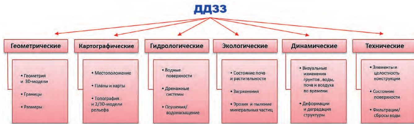
Рис. 1 Классификация наблюдаемых контролируемых параметров и характеристик (геоиндикаторов) объектов размещения отходов горного производства на основе методов дистанционного зондирования Земли
