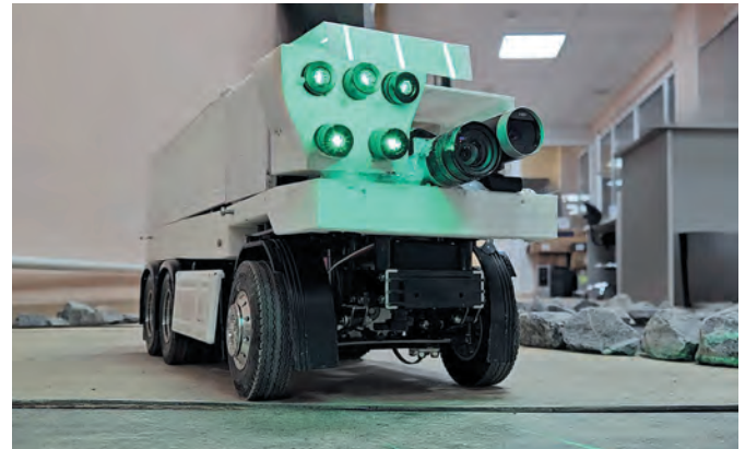
Рис. 1 Внешний вид масштабной модели АТС с системой машинного зрения
