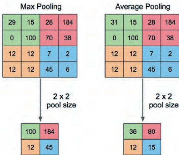
Рис. 1 Примеры усредняющего и максимизирующего пулинга на изображении угольной породы
