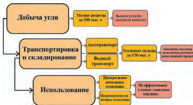
Рис. 1 Блок-схема технологической цепочки поставок угольной продукции в арктические районы Республики Саха (Якутия)
