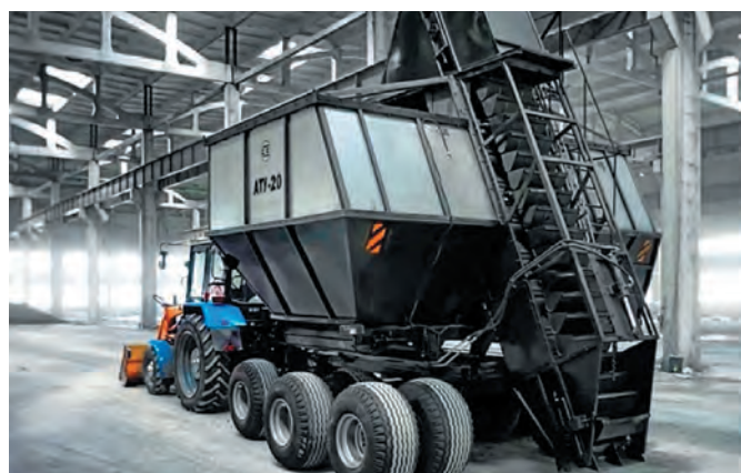
Рис. 3 Машины для фрезерного способа добычи торфа Источник: Машина для уборки фрезерного торфа АМКОДОР АТУ-20. Режим доступа: https://koenigagro.ru/catalog/mashina-dlya-uborki-frezernogo-torfa-amkodor-atu-20/ (дата обращения: 16.10.2024)
