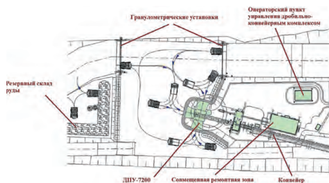
Рис. 6 Схема размещения ДПУ в ограниченном пространстве карьера
