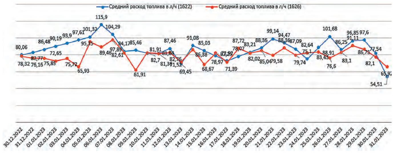
Рис. 5 Сравнительная диаграмма среднесуточного расхода топлива в январе для машины с неисправностями (синяя линия) и без (красная линия)
