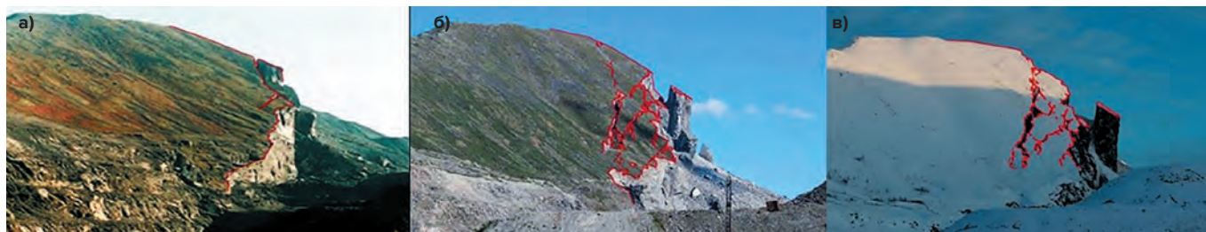
Рис. 1 Изменение конфигурации поверхностной части массива горных пород месторождения Апатитовый Цирк: а – сентябрь 2001 г., б – август 2018 г., в – октябрь 2023 г.
