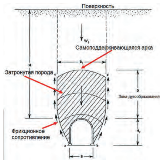
Рис. 3 Схема расчета нагрузок на крепь
