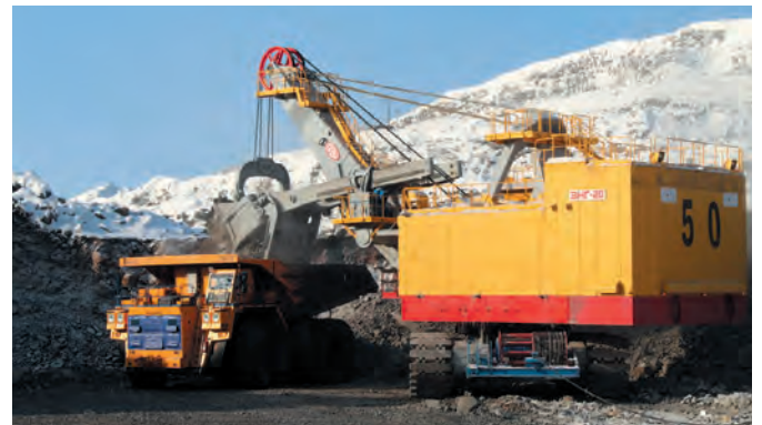
Электрический экскаватор ЭКГ-20 предназначен для вскрышных работ
