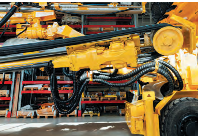
Гидравлический перфоратор HLX5-MX производства АО «Машиностроительный холдинг» на первой буровой установке DF-C2
