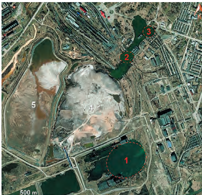
Рис. 1 Космоснимок района катастрофического поражения карстовыми провалами в г. Березники (база данных ESRI). Обозначения: 1 – провал «Большой брат» на БПКРУ-1; 2 – провал «Малыш» на железнодорожной станции Березники; 3 – провал «Кроха» около шахтостроительного управления; 4 – солеотвал; 5 – шламохранилище
