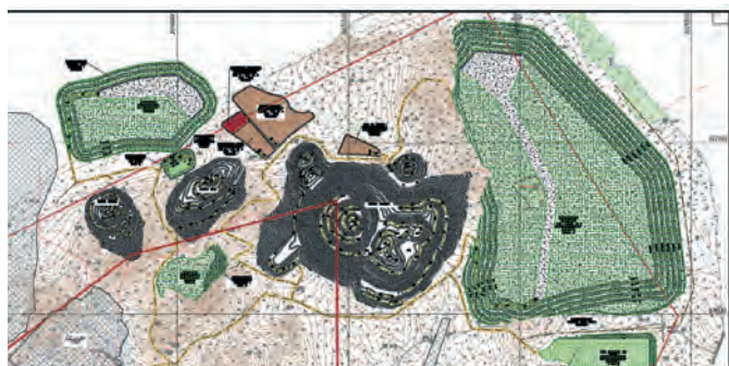
Рис. 3 Проектируемый результат совмещения рекультивации и отсыпки отвалов
