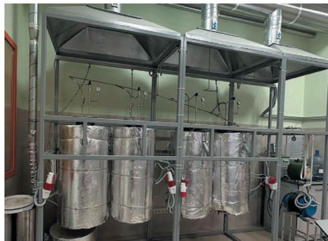
Рис. 1 Лабораторная установка замедленного коксования с загрузкой сырья до 80 кг («ЛУЗК»)
