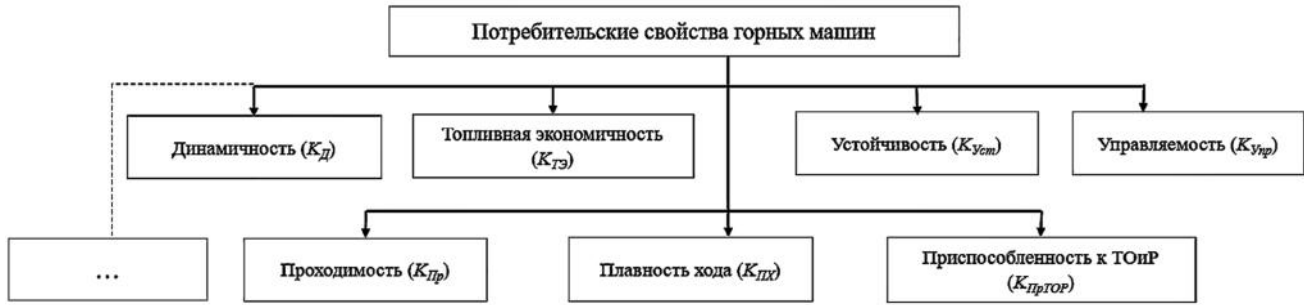
Рис. 3 Структурная модель оценки функциональных возможностей горных машин (в рис индексы строчными буквами)
