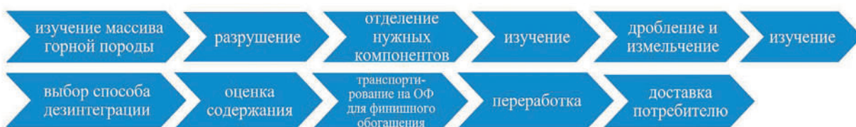
Рис. 1 Требуемая структурная схема разработки «умного» горнодобывающего предприятия
