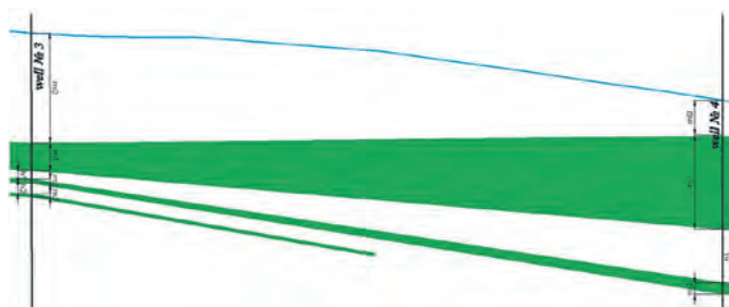
Рис. 3 Схема расположения пластов полезного ископаемого по данным скважин «well N°3» и «well N°4»
