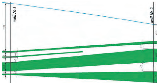
Рис. 2 Схема расположения пластов полезного ископаемого по данным скважин «well N°1» и «well N°2»
