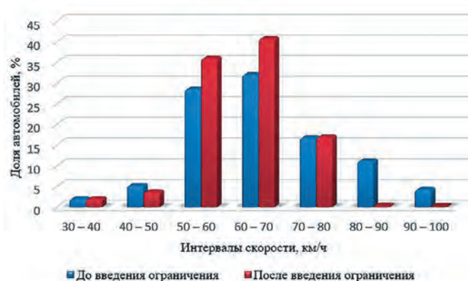
Рис. 2 Распределение автомобилей по скоростям движения на автомобильных дорогах угольного разреза до и после введения ограничения скорости движения
