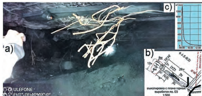
Рис. 2 Фото объективных и реальных разрушений при выбросе метана и горном ударе: а – фрагмент фотографии образовавшейся полости в угольном пласте и разорванной затяжки крепления выработки; б – фрагмент выкопировки из плана горных выработок шахты с результатами измерения размеров полости в пласте и выброшенного угля; с – график времени выброса метана из пласта
