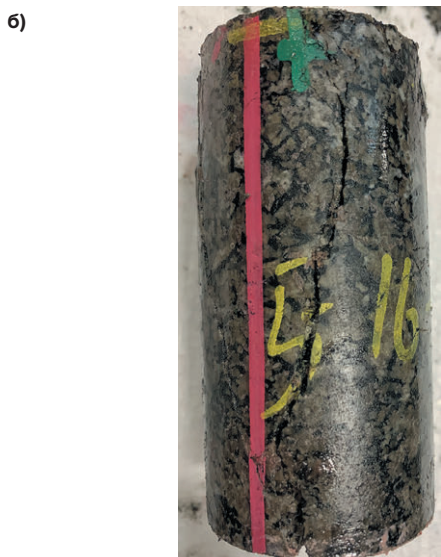
Рис. 1 Испытание образца ийолит-уртита в условиях трехосного осесимметричного сжатия: а – образец, подготовленный для испытания; б – образец после испытания
