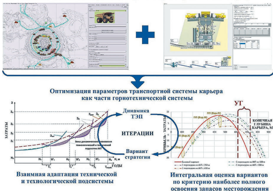
Рис. 4 Оптимизации транспортной системы глубокого карьера на примере циклично-поточной технологии
