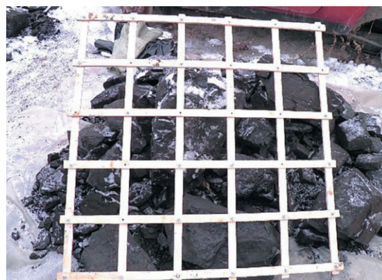
Рис. 1 Крупность угля в забое в холодный период года: а – в автотранспорте, б – в навалe (ячейки решётки 300*300 мм)
