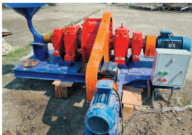
Рис. 1 Общий вид и основные конструктивные параметры опытного образца роторной дробилки многократного ударного действия РД-МДВ-900
