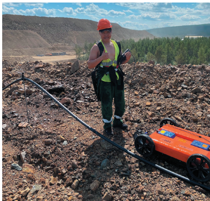
Рис. 1 Исследования на участке георадаром «ОКО-3» с антенным блоком АВ-100МЗ (100 МГц)
