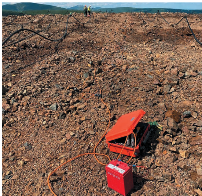
Рис. 2 Многоэлектродная электроразведочная аппаратура Скала 48К12
