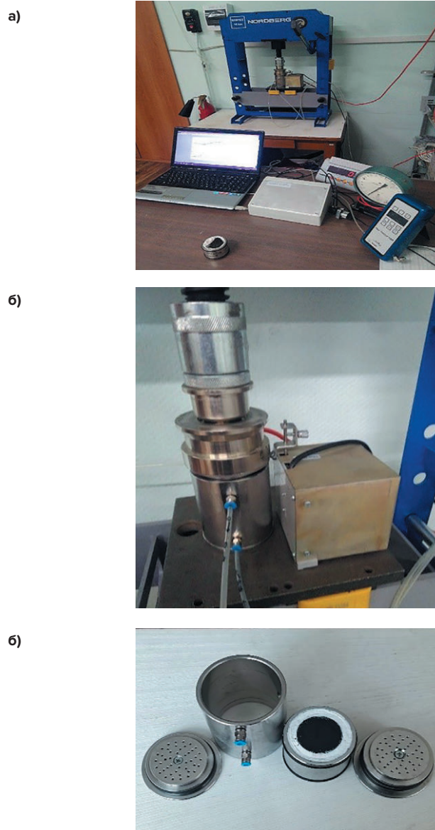
Рис. 3 Фотографии стенда для исследования «поршневого механизма»: а – фотография пресса; б – металлический модуль с угольным образцом внутри; в – угольный образец, вклеенный в металлический модуль
