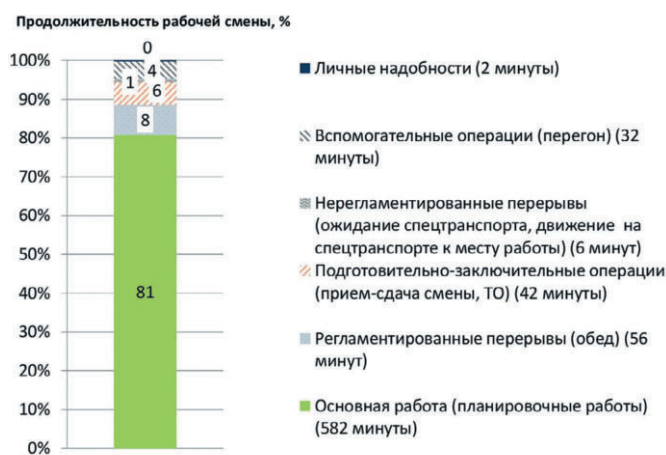
Рис. 2 Структура сменного фонда времени работы машиниста бульдозера по результатам хронометража (04.03.2025, 1 смена, время наблюдения 12,5 ч)
