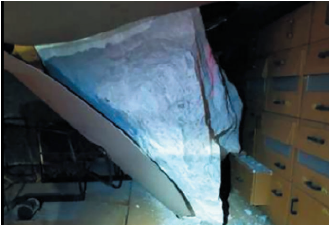
Рис. 6 Кусок породы, лежащий на палубе CAT 794 после разрушения защитного козырька
