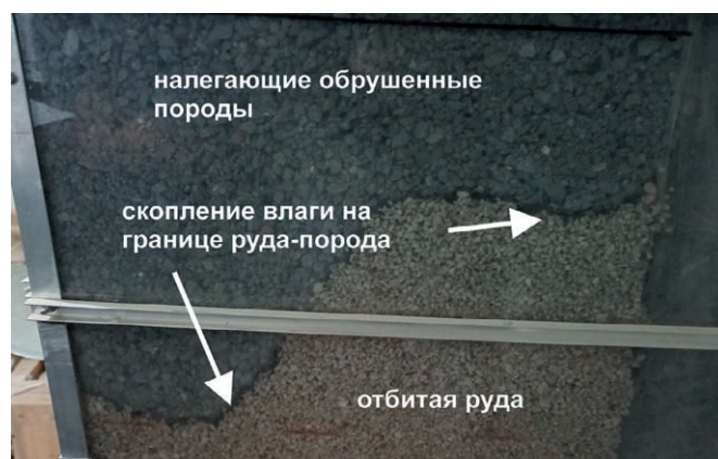
Рис. 2 Выпуск руды из стенда в криокамере увлажненной руды при температуре -5°C
