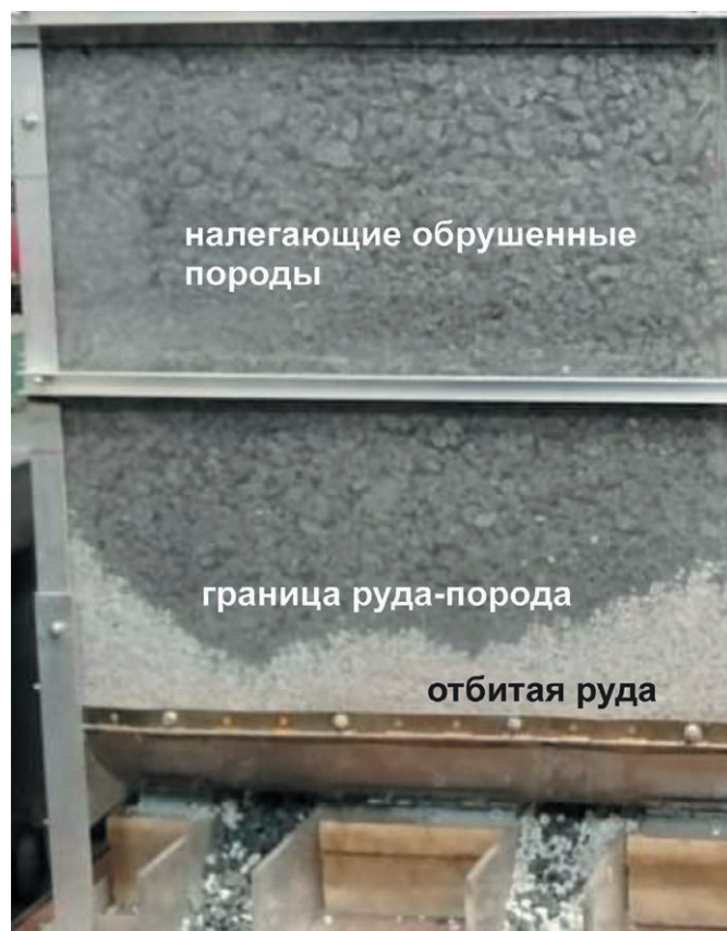
Рис. 3 Выпуск руды из стенда в криокамере при температуре –7°C без увлажнения
