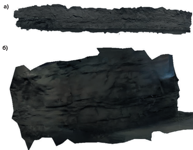
Рис. 4 Результат построения фотограмметрической модели стенки (а) и торца (б) горной выработки в условиях низкой освещенности (подсветка видеокамеры БПЛА)
