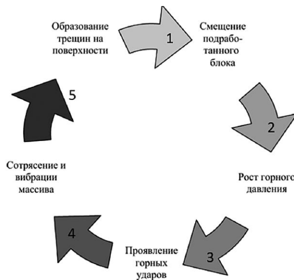
Рис. 1 Модель эволюционного взаимодействия между геодинамическими системами разных рангов на шахте Хуафэн
