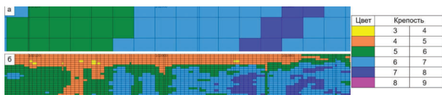
Рис. 4 Графическое сравнение фактического (а) и расчетного (б) показателя трудности бурения
