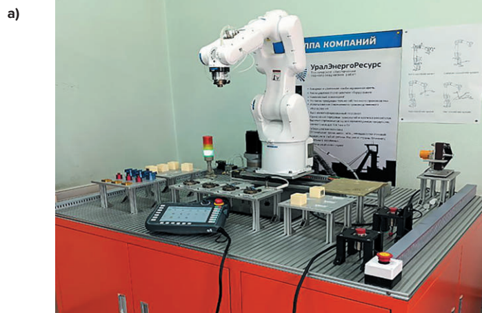
Рис. 6 Лабораторная учебная ячейка: а – лабораторно-технический комплекс; б – интерактивный пульт управления и программирования манипулятора; в – захваты для имитации технологических процессов
