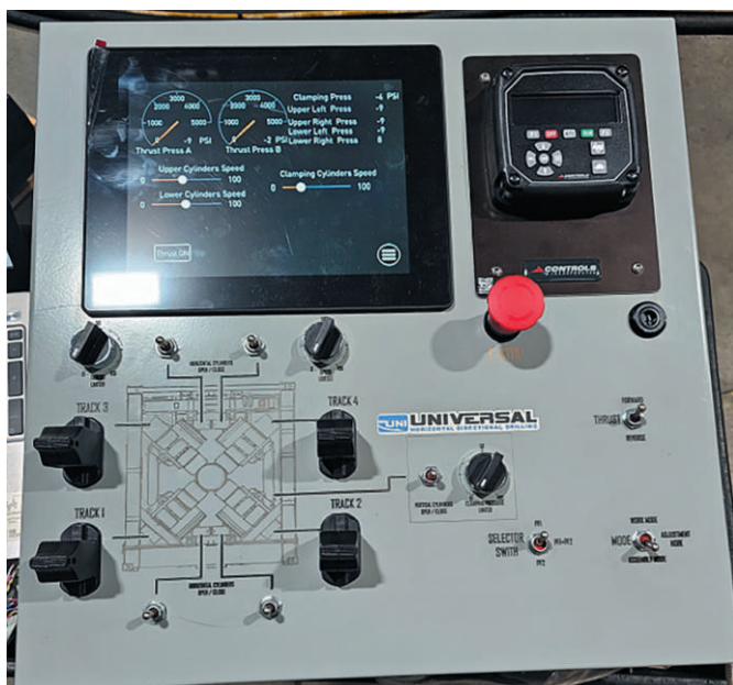
Рис. 2 Пульт управления роботизированной системы для домкратного продавливания труб UNI Pipe Feeder 200 с усилием 250 т
