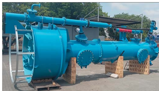
Рис. 5 Колонные флотомашины в лабораторном промышленном исполнении
