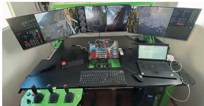
Рис. 4 Рабочее место оператора автоматического и дистанционного управления буровзрывных работ в удаленном центре управления
