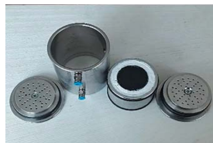
Рис. 3 Фотографии стенда для исследования «поршневого механизма»: а – фотография пресса; б – металлический модуль с угольным образцом внутри; в – угольный образец, вклеенный в металлический модуль
