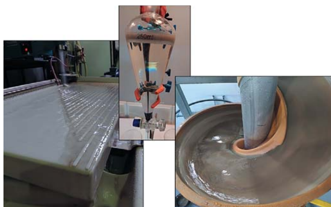
Рис. 3 Гравитационное обогащение в лабораторном и полупромышленном исполнении
