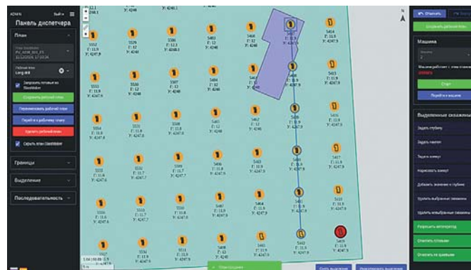
Рис. 6 Отображение плана проведения буровзрывных работ на экране рабочего места оператора
