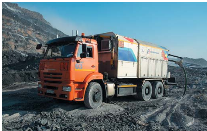
Смесительно-зарядные машины оборудовали планшетами с программой ОНИКС. Так водитель видит, сколько взрывчатого вещества нужно зарядить в определённую скважину
