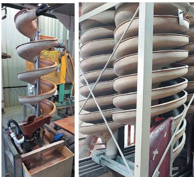
Рис. 6 Винтовые сепараторы в лабораторном и промышленном исполнении
