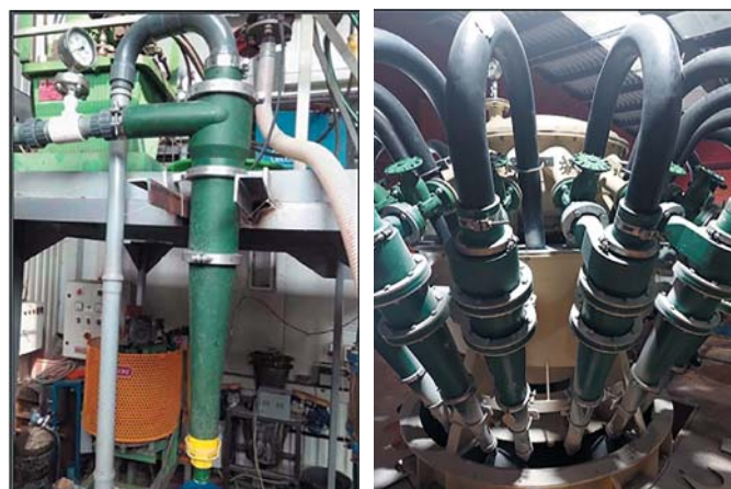
Рис. 4 Гидроциклоны в ЦИМС и на промплощадке ГОК
