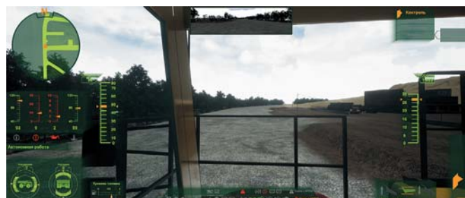
Рис. 3 Отображение оперативной информации на экране рабочего места оператора высокоавтоматизированным погрузочно-доставочным комплексом
