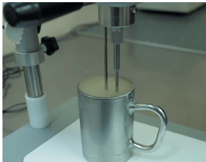
Пробы эмульсии берут вручную каждые 10 мин во время приготовления. Также на взрывном блоке лаборанты анализируют пробы готовой продукции из каждой машины
