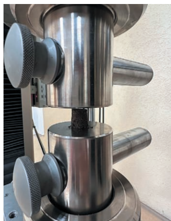
Рис. 2 Осевое сжатие на универсальной испытательной машине Zwick Roell Z100
