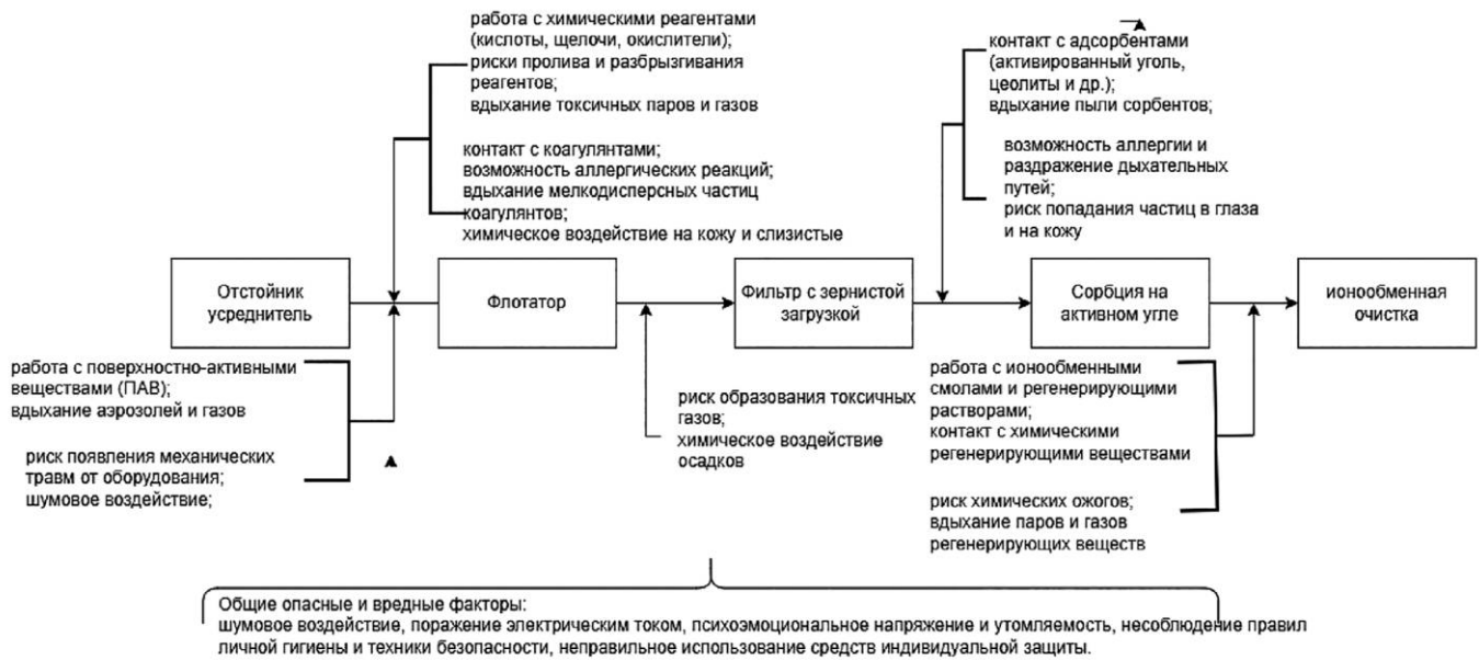
Рис. 1 Технологическая схема по очистке сточных вод на угольном предприятии с выявлением опасных и вредных факторов в работе оператора
