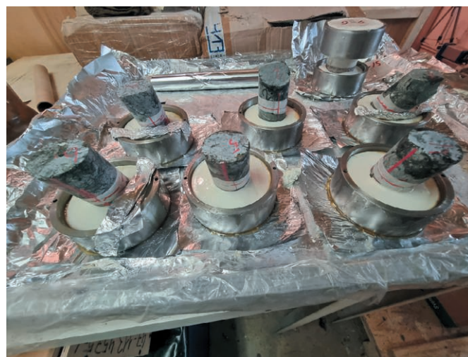
Рис. 1 Образцы уртыта, подготовленные для проведения испытаний на сдвиг по трещине
