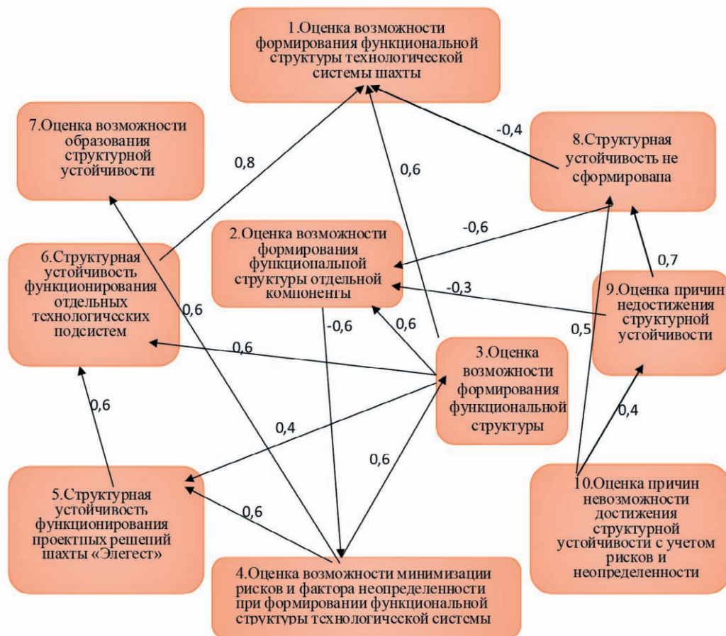
Рис. 3 Нечеткая когнитивная карта оценки достоверности когнитивного моделирования технологической системы шахты
