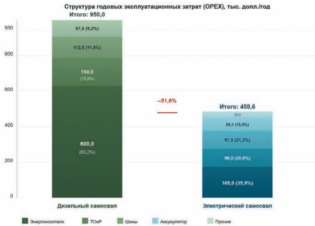
Рис. 1 Сравнительная структура годовых эксплуатационных затрат дизельного и аккумуляторного электрического карьерного самосвала грузоподъёмностью 150 т (базовый сценарий)
