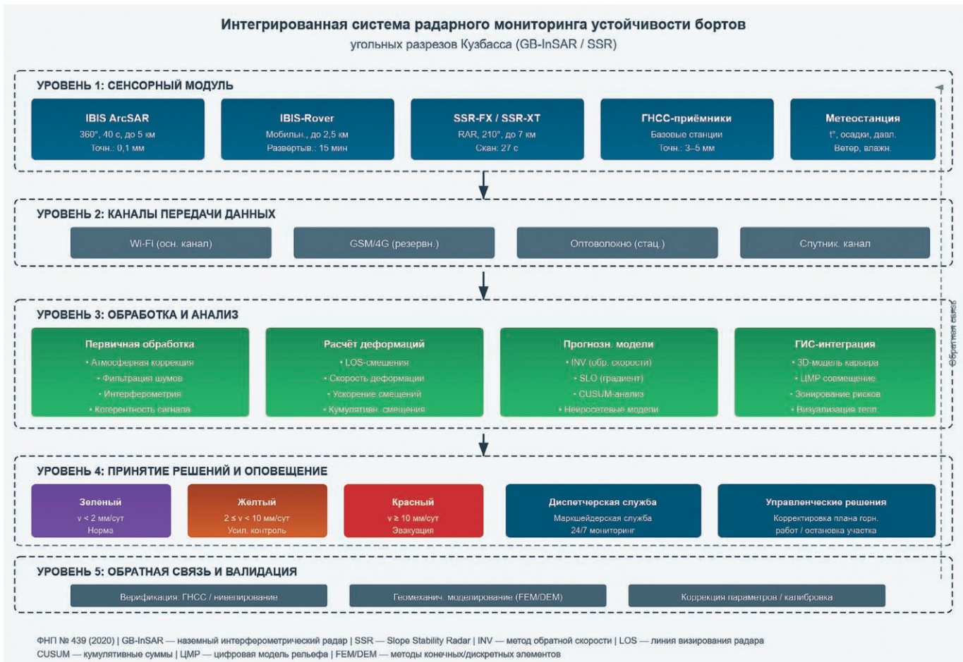
Рис. 1 Структурная схема интегрированной системы радарного мониторинга устойчивости бортов угольных разрезов Кузбасса
