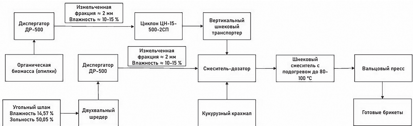
Рис. 1 Технологическая схема подготовки брикетированного вторичного топлива
