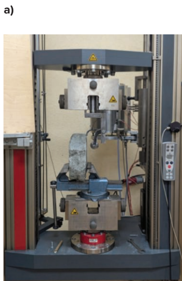
Рис. 2 Экспериментальная установка с комбинированным породоразрушающим инструментом (а) и график усилия резания глины одиночным резцом (б)
