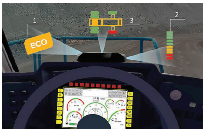
Рис. 2 Индикаторы проекционного экрана на лобовом стекле
