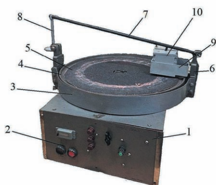
Рис. 1 Установка ЛКИ-3: 1 – пульт управления; 2 – кнопка запуска и остановки вращения; 3 – выходной вал мотор-редуктора; 4 – чугунный диск; 5 – сменный стальной диск с закреплённым на нем абразивным материалом; 6 – кронштейн; 7 – штанга; 8 – груз; 9 – оправка; 10 – каретка с испытываемым образцом (фото авторов)
