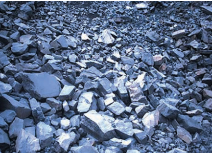
Рис. 2 Снимки горной массы и анализ гранулометрического состава взорванного блока №1-2 при применении электронных детонаторов
